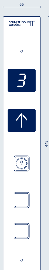
BT 3 Bedientableau mit zwei Ruftastern, Weiterfahrtpfeilen, LED-Anzeige und Schlüssel für Sonderfunktionen
