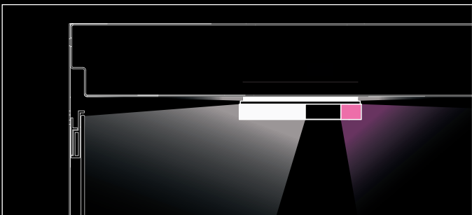
Vertikalschnitt LD7-NEO-LED-RGB-Wandfluter. Funktionsschema Direkt- und Indirektbeleuchtung.
