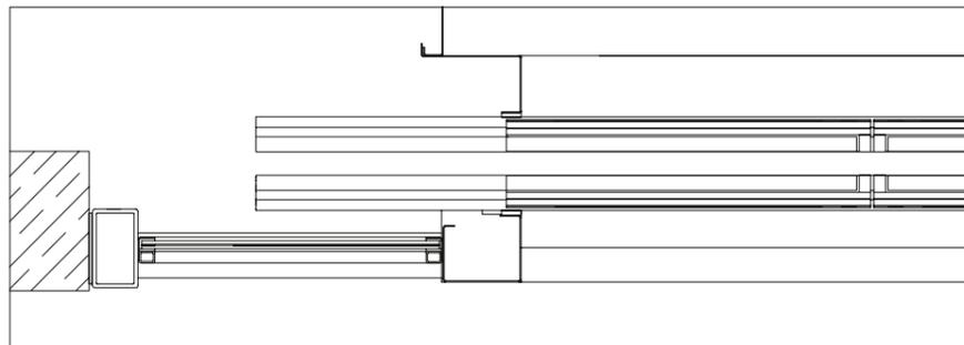
Horizontalschnitt Kabinen- und Schachttür.
