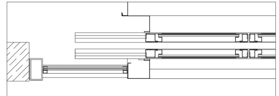
Horizontalschnitt Kabinen- und Schachttür.
