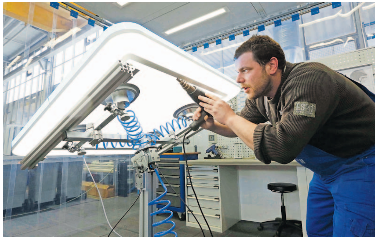
Christian Engerer erledigt Elektroarbeiten an einer Beleuchtung bei den Aufzugswerken Schmitt + Sohn GmbH & Co. KG mit Sitz an der Hadermühle: Die einzelnen Komponenten können je nach Modell ganz individuell zusammengestellt werden.
